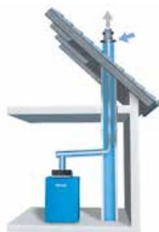
Raumluftunabhängig mit konzentrischem Luft-Abgas-System aus Kunststoff im Kamin oder Schacht
