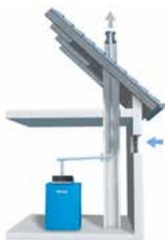
Raumluftabhängig mit eingezogenem Abgasrohr im Kamin (Zuluft über Belüftungsöffnung)
