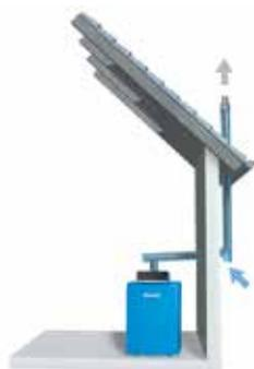
Raumluftunabhängig mit konzentrischem Kunststoff-Luft-Abgas-System zur Abgasführung an der Außenwand
